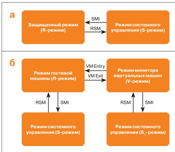
Рис. 4. Схемы переключения между режимами работы процессора при выполнении набора безусловно перехватываемых инструкций в случаях его отсутствия (а) и присутствия (б)
