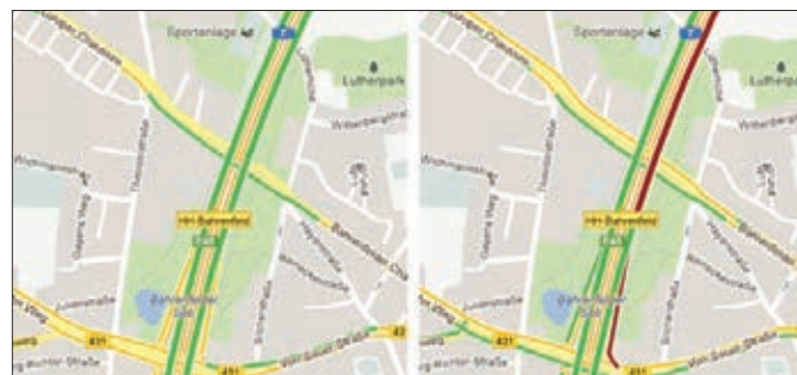
Рис. 3. Результат эксперимента Тобиаса Еске по подделке трафика в Google Navigation. Скриншот перед спуфингом (слева) и после успешной атаки (справа)
