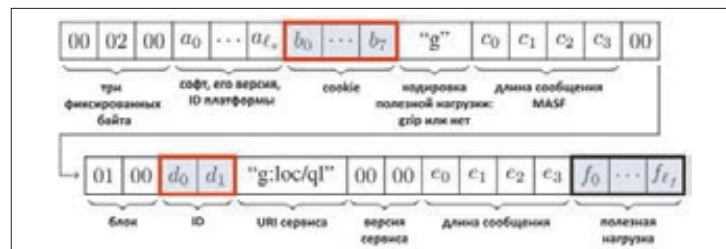
Рис. 2. Структура пакета, отправляемого в Google с Android-устройства. Протокол основан на фреймворке MASF (Mobile Sensing Application Framework)
