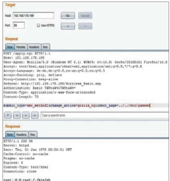
Пример эксплуатации уязвимости типа «раскрытие путей» в роутере E1500
